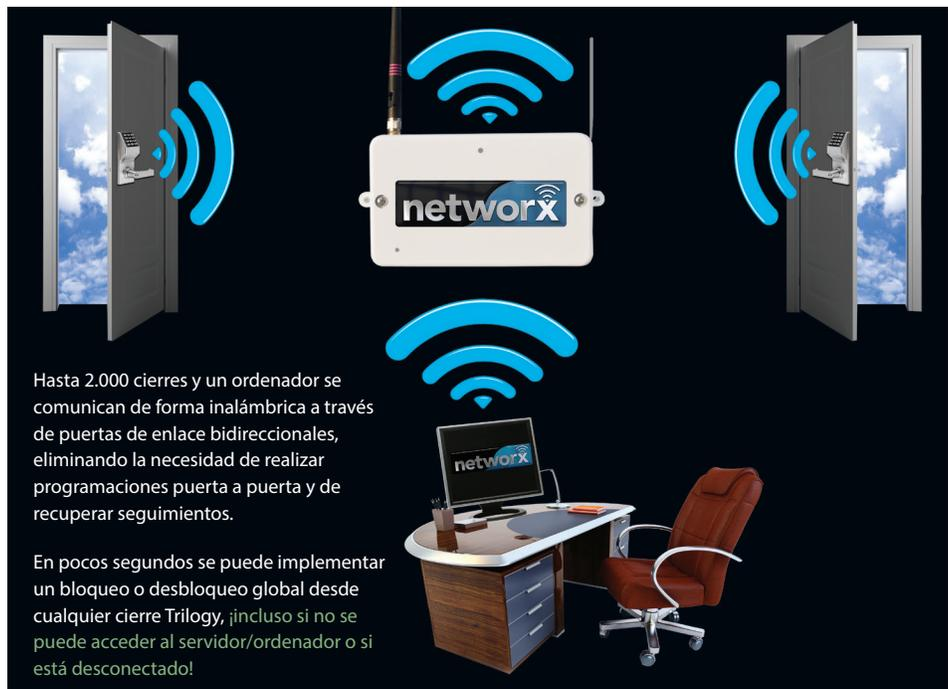
Hasta 2.000 cierres y un ordenador se comunican de forma inalámbrica a través de puertas de enlace bidireccionales, eliminando la necesidad de realizar programaciones puerta a puerta y de recuperar seguimientos.
